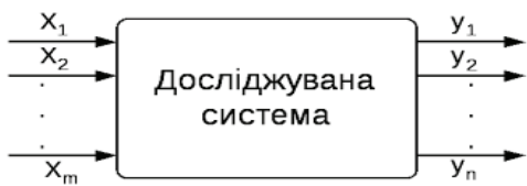
Рис. 1. Схематичне зображення методу «факторна модель» (так звана «чорна скринька»)
