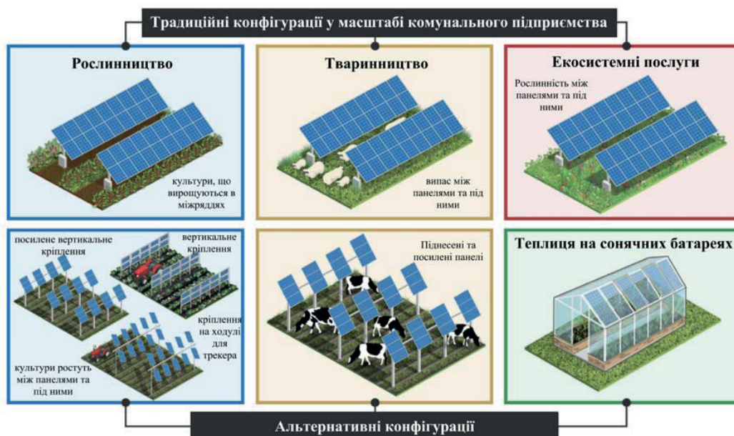
Рис. 2. Типи агроелектричних систем, які були розгорнуті в промисловості в США [4]
